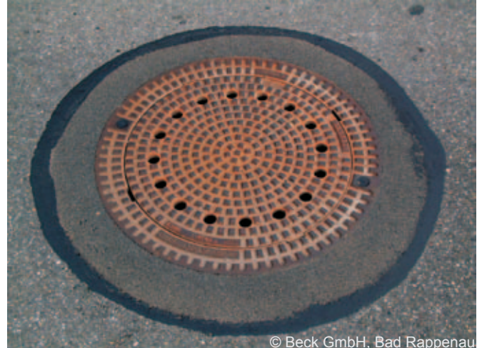
Schachtabdeckung, LW 605, Klasse D 400, System Bituplan®, Rahmen aus Gusseisen, Deckel aus Gusseisen mit Lüftungsöffnungen
