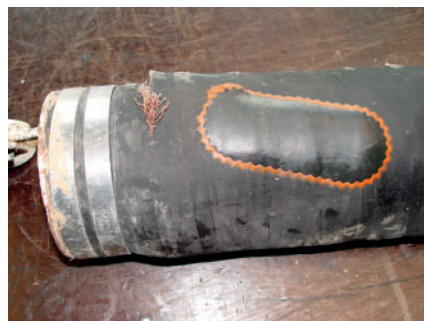
z.B. kompletter Außengummi wechseln und neu vulkanisieren
