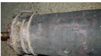
z.B. einen abgerissenen Deckel in einen alten Packergummi vulkanisieren
