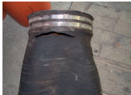
z.B. kompletter Außengummi wechseln und neu vulkanisieren
