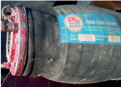
z.B. Loch am Umfang mit Gummi und Gewebe vulkanisieren
