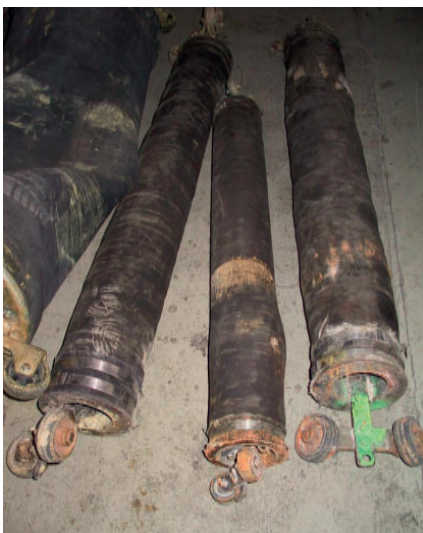
z.B. kompletter Außengummi wechseln und neu vulkanisieren
