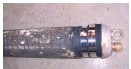
z.B. einen abgerissenen Deckel in einen alten Packergummi vulkanisieren
