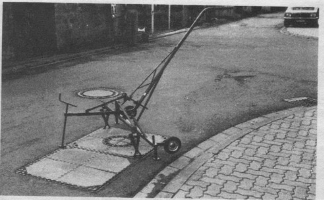
Abb. 5: Der Schachtdeckel-Hebewagen für Kabelschacht-Abdeckungen — Typ HK — mit Zusatz-Hebespindel.
