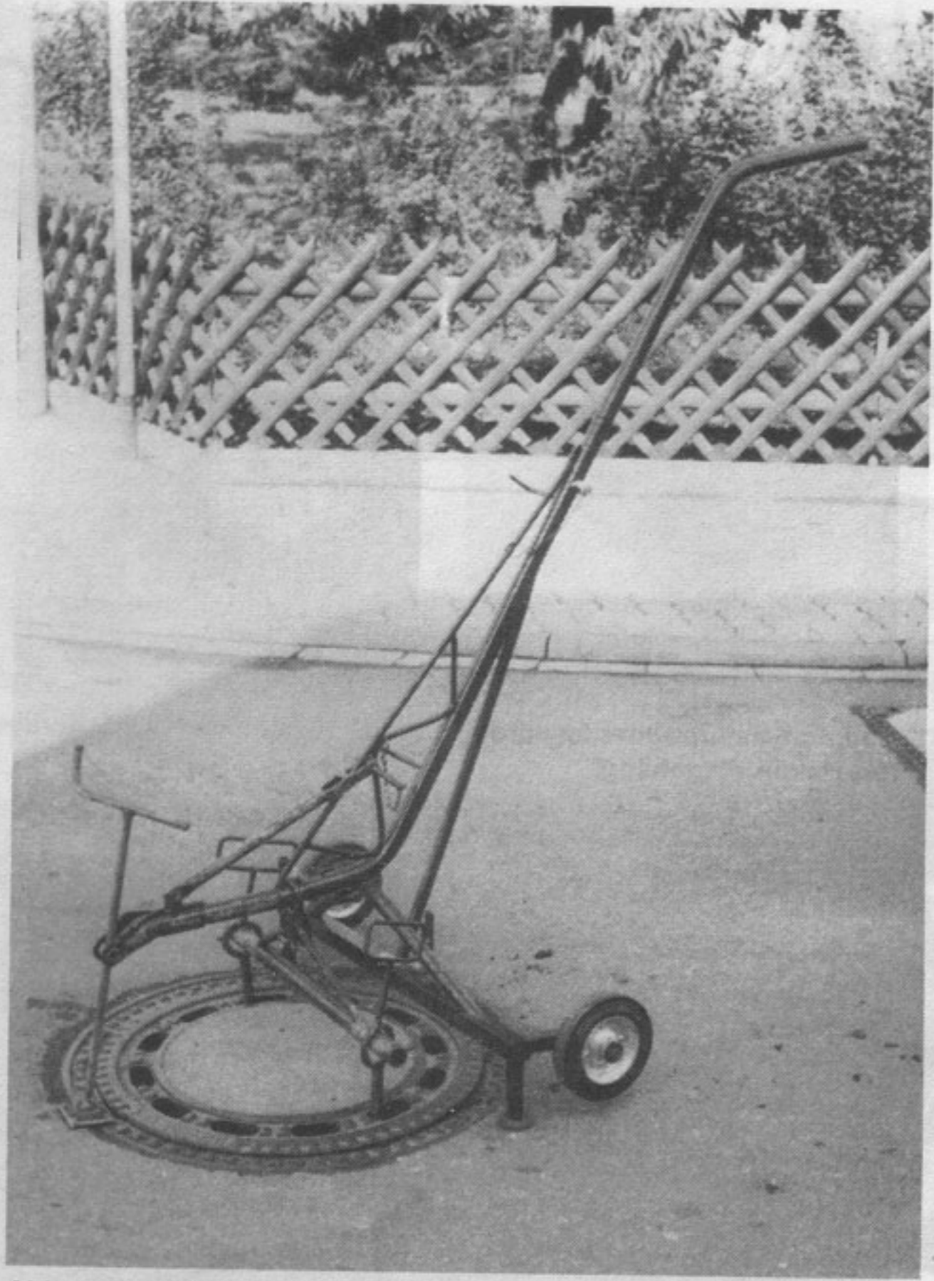
Abb. 3: Der Schachtdeckel-Hebewagen für Runddeckel mit Zusatz-Hebespindel.
