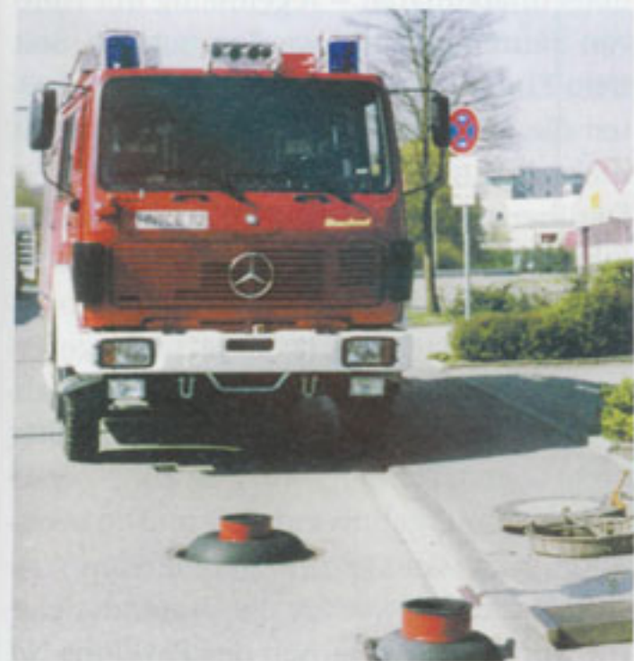
Schacht- und Rohrverschlüsse beim Feuerwehreinsatz
