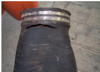
z.B. kompletter Außengummi wechseln und neu vulkanisieren
