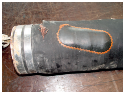
z.B. kompletter Außengummi wechseln und neu vulkanisieren
